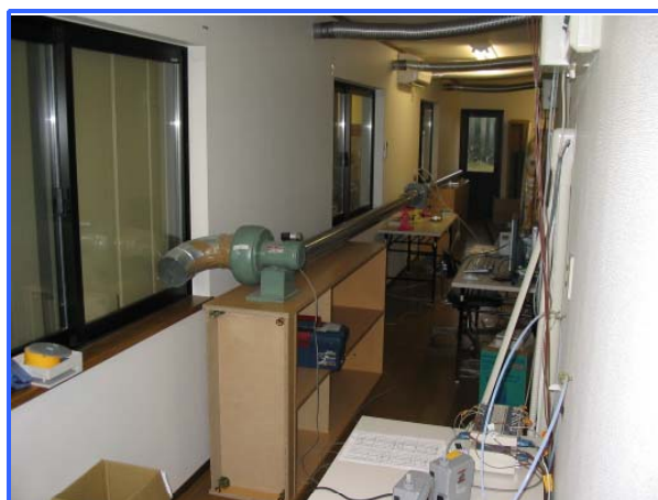
写真2-1 風量測定用簡易風洞
