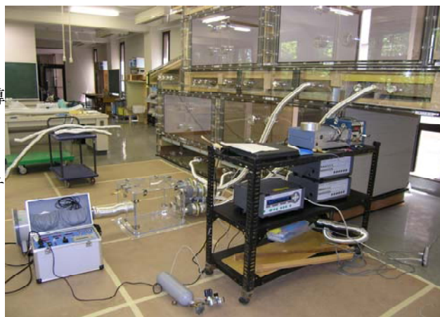
写真2-15 トレーサーガス法による給気量測定
