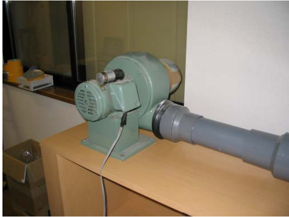
写真2-3 送風機及び風量制御インバータ
