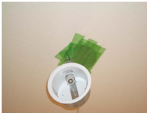
写真 2-9 天井懐へのトレーサーガス供給状況
