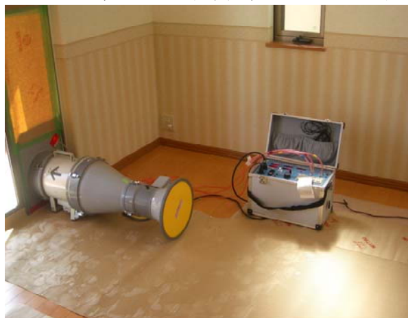
写真 2-7 気密性能の測定状況
