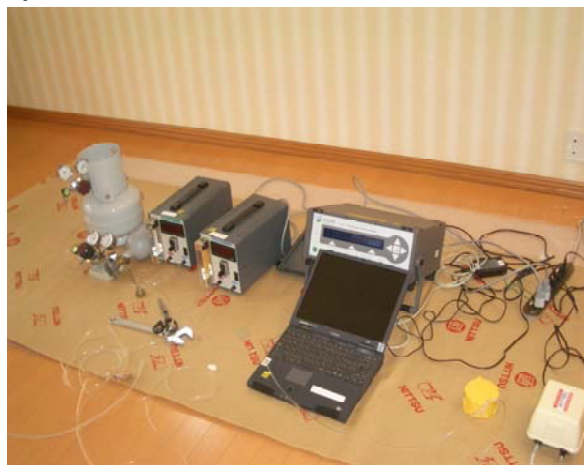
写真 2-8 トレーサーガスの発生器と濃度測定器
