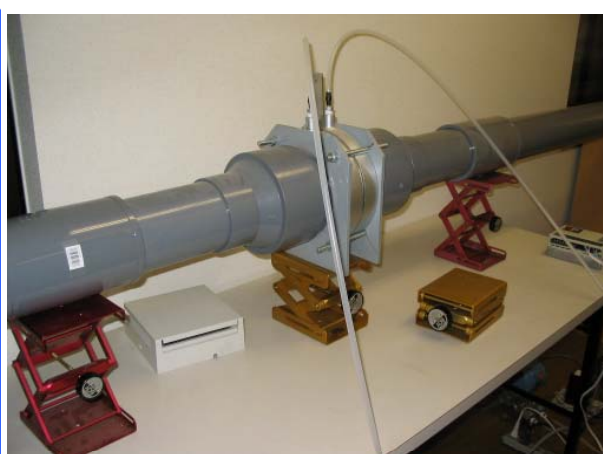
写真2-2 オリフィスを用いた風量測定
