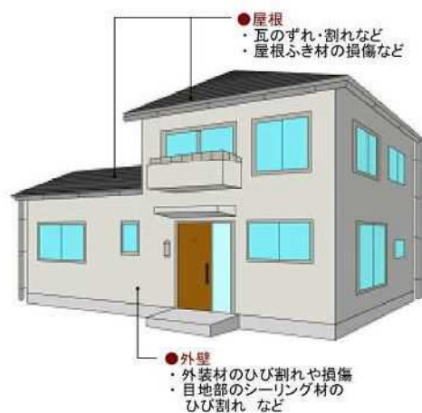
外壁や屋根の不具合の例
